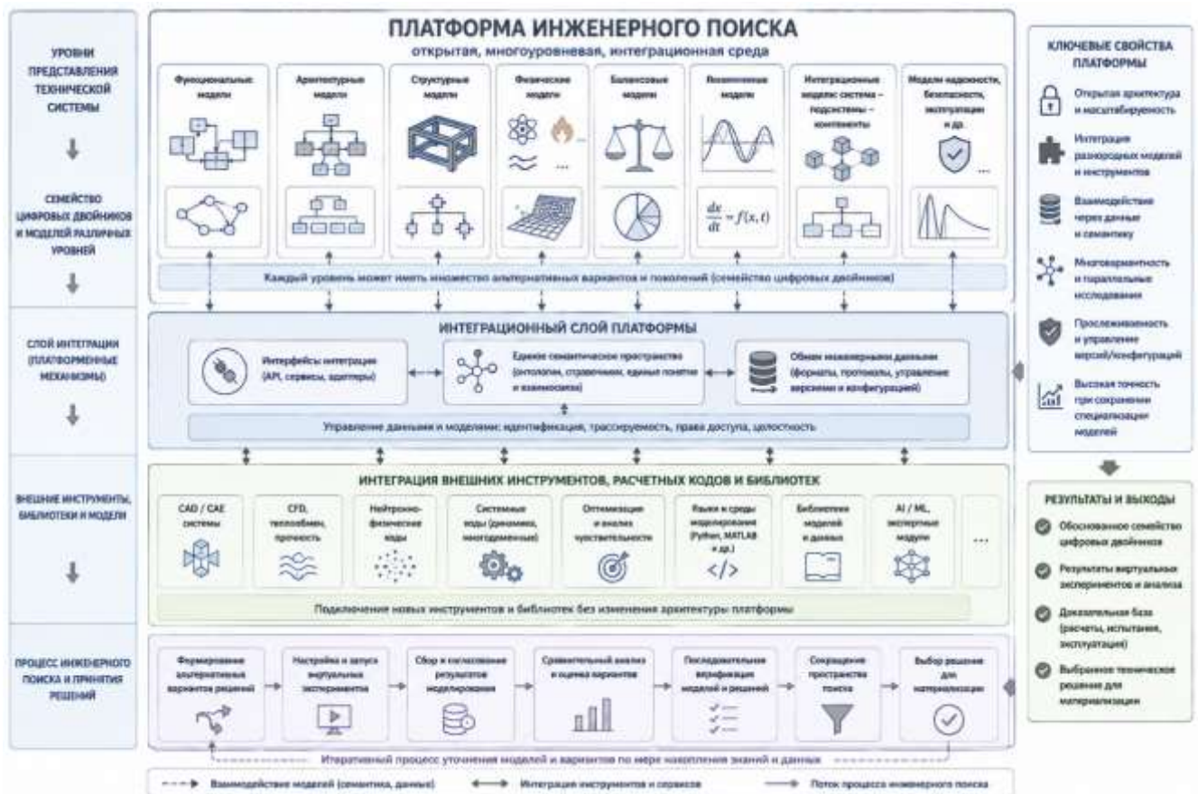
Рис. 2. Платформа инженерного поиска: многоуровневая интеграция моделей, внешних инструментов и семейства цифровых двойников вариантов создаваемой технической системы
