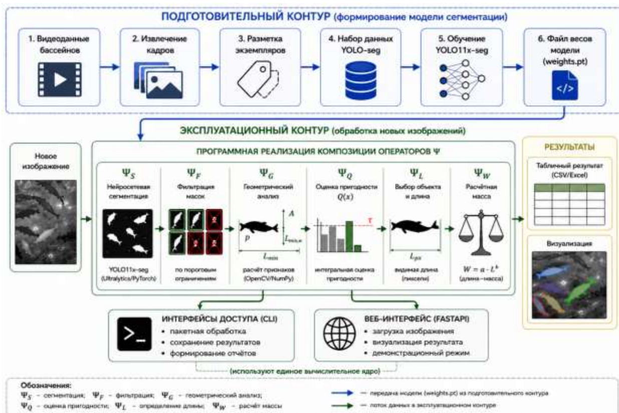
Рис. 1 Архитектура программной реализации предложенного метода бесконтактной оценки длины и расчётной массы рыбы
