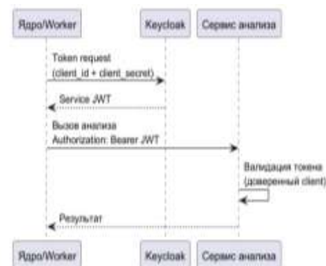
Рис.5. Схема безопасности доступа к сервисам анализа
