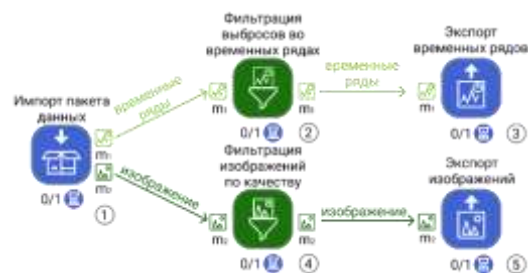
Рисунок 3 – Структура аналитического процесса первичной обработки данных промышленного мониторинга
