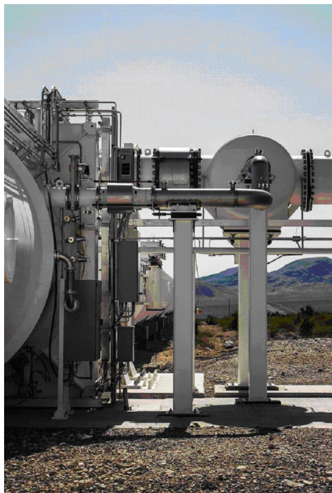
Рис. 5. Часть вакуумного оборудования на полигоне Virgin Hyperloop One. Низкое давление в вакуумной трубе Hyperloop сводит к минимуму трение и сопротивление воздуха, значительно снижая необходимую мощность (источник -The New York Times).
