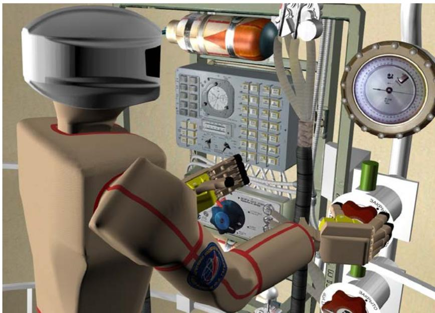
Рис. 3. Поворот вентиля с помощью антропоморфного робота
