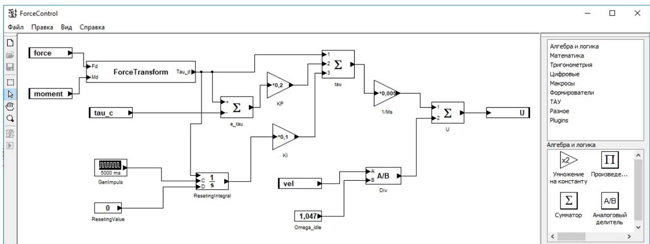
Рис. 2. Схема регулятора в редакторе функциональных схем
