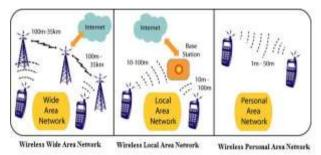
Рис. 1. Типы беспроводных сетей.
