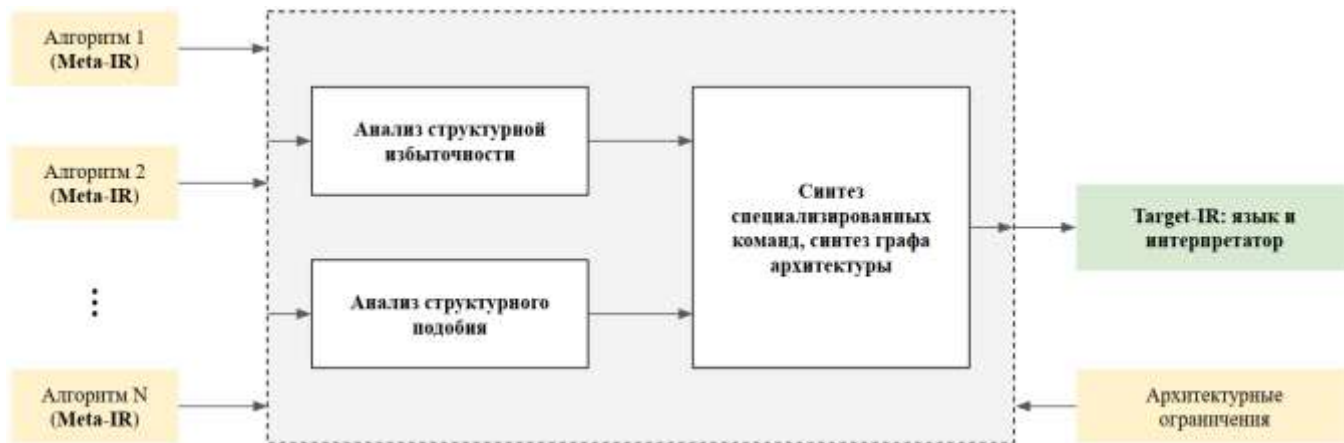
Рис. 3. Схема индуктивного синтеза представления Target-IR
