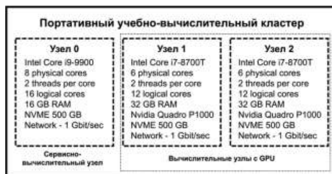
Рис. 1. Аппаратная конфигурация портативного учебно-вычислительного кластера, включающего сервисно-вычислительный узел и два вычислительных узла.
