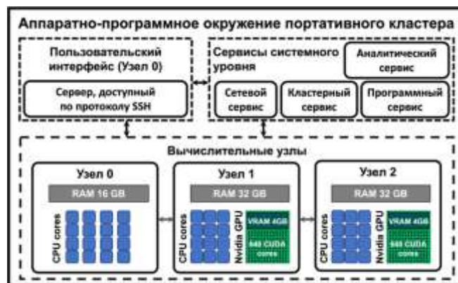
Рис. 2. Структура аппаратно-программного окружения портативного кластера HybriLIT.
