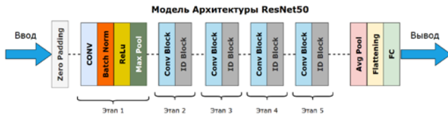
Рис. 6. Архитектура ResNet50 [14]. Здесь Batch norm – нормализация пакета данных; ReLu – функция активации; Max pool – пулинг по максимальным значениям; ID Block – ResNet блок.
