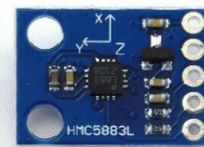
Рис. 24 – модуль компаса HMC5883L
