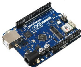
Рис. 22 - плата Arduino Uno WiFi Rev. 2
