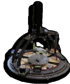
Рис. 20 – Установка реализуемой системы для съемки фотоизображений
