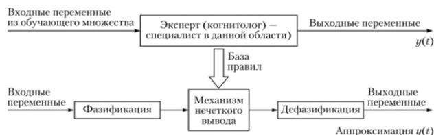
Рисунок 2 – Схема архитектуры нечеткой системы управления
