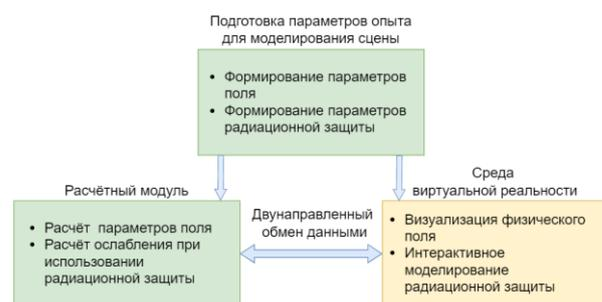
Рис.2 - Схема взаимодействия логических блоков системы интерактивного моделирования
